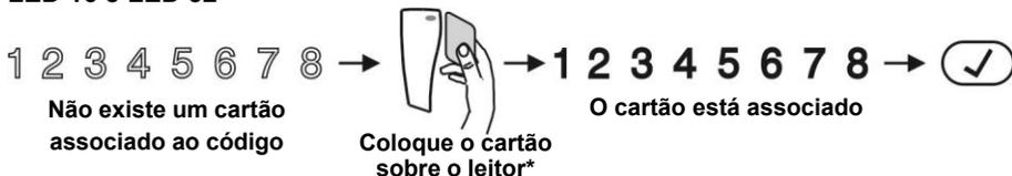
O cartão é reconhecido no visor LED com dígitos de 1 a 8 permanentemente iluminados. Se o registo do cartão com um código de utilizador for bem sucedido, após pressionar o botão ENTER, um bip de confirmação será ouvido. Se o cartão já está associado a um utilizador diferente, um sinal de rejeição é ouvido
